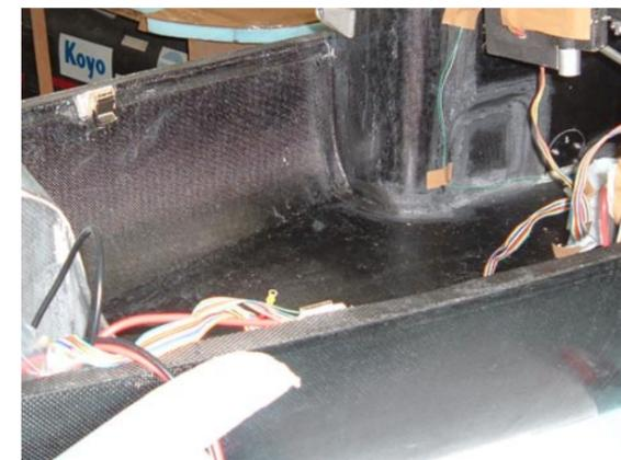
Fig.3 ツインチューブに替わり採用された、高めのサイドウォール
