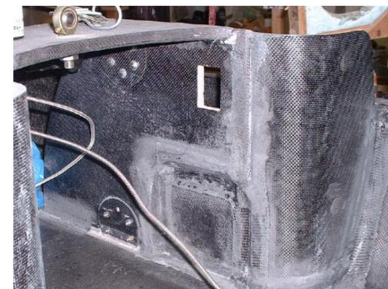
Fig.4 アンダーカウル内部の変更で、防水性能も改善された
