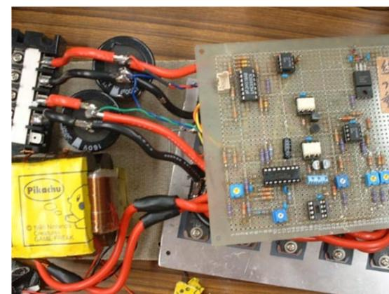
Fig.3 昨年度作成の回生用絶縁DCDCコンバータ
