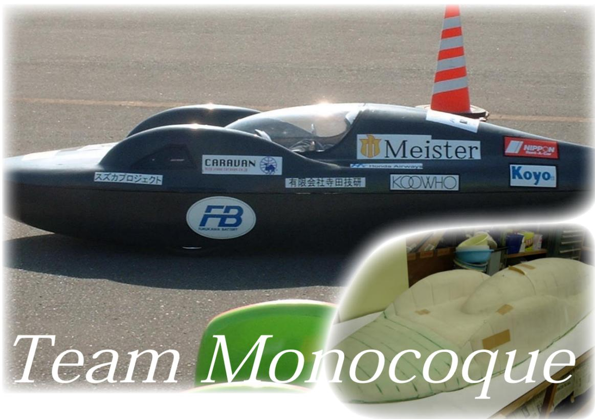
チームモノコックでは昨年度に引き続き採用したモノコックフレームの製作を行っています。フレームパーツの大半はバルサ及びハニカムをコア材としたCFRPサンドイッチパネルにより構成されており、これらを適宜二次接着して組み立てています。またこれらは殆どは常温硬化樹脂を用いたハンド・レイアップ法により製作しています。
