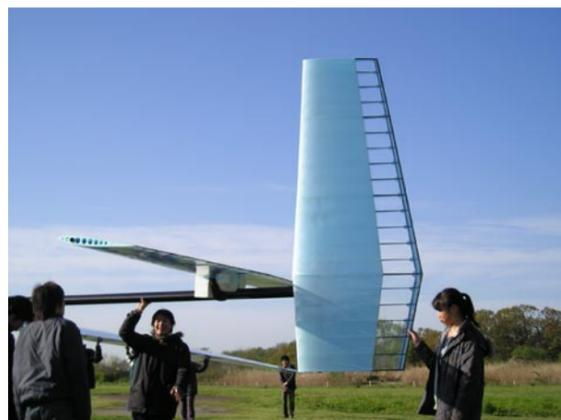
Fig.2 水平尾翼と垂直尾翼
